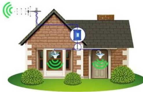
Gambar 1. Penerapan Booster 4G LTE pada bangunan Sumber (Lanyi Antenna, 2024)
